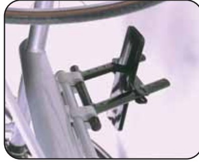
Pedana regolabile in altezza e profondità
