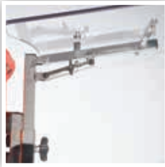
Regolazione manuale inclinazione tavolino Table tilt manual adjustment
