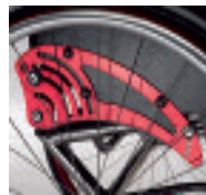
Supporto spondina con regolazione inclinazione schienale Clothes guard support allowing back-rest tilt adjustment
