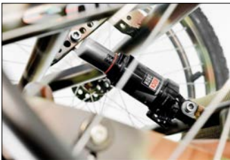
Ammortizzatore RockShox. Dampened seat.
