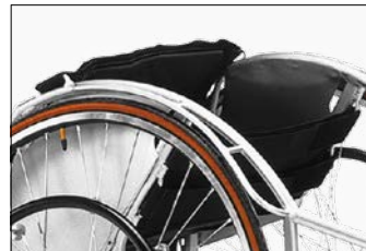
Tela schienale e sedile regolabili.
