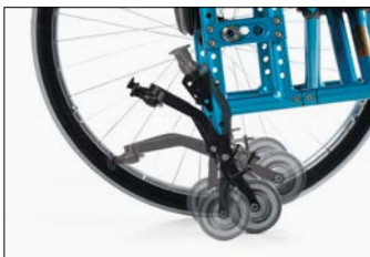
Ruotine per passaggi stretti a leva. Lever activated narrow passage wheels.
