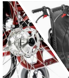
Freni a tamburo azionati dall'assistente. Drum brakes, assistant-activated.
