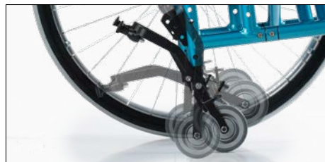
Ruotine per passaggi stretti a leva. Lever activated narrow passage wheels.
