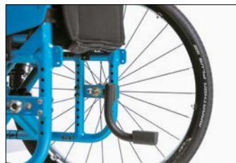
Pedale di sbilanciamento. Unbalancing pedal.
