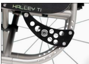
Ampio range di scelta di altezze posteriori e sbilanciamento grazie alla piastra AwP Wide range of axle positions and heights thanks to the AwP plate
