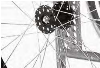
Regolazione baricentro e altezza posteriore Adjustable rear height and centre of gravity
