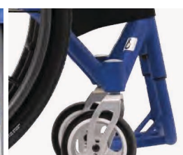
Punto d'aggancio WTORS anteriore Front WTORS anchor point
